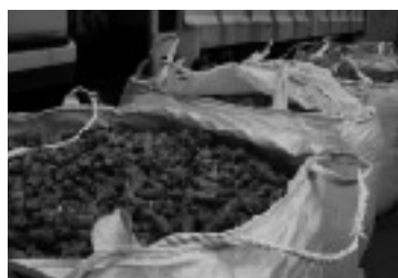
▲製造された固形燃料（RPF）は、製紙工場のボイラー用燃料に使われています
