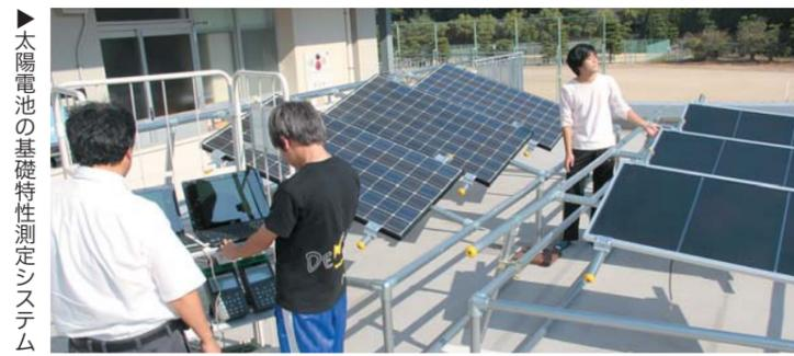
▶太陽電池の基礎特性測定システム
