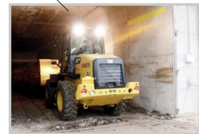
▲トンネルの中で微生物がごみを分解。残ったごみは重機を使って選別機へ運びます
