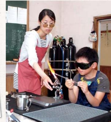
集中してガラス棒をバーナーで溶かします
