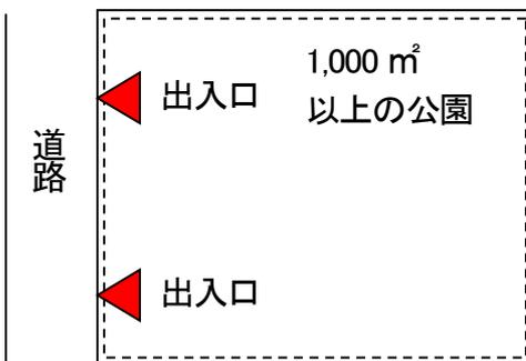
出入口を二箇所以上配置する規定は、避難経路を二方向に確保するという主旨なので、一辺に2箇所の出入口を設けても2箇所配置したことにはならない。
