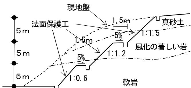
上端、下端、小段には排水施設を設置する。
