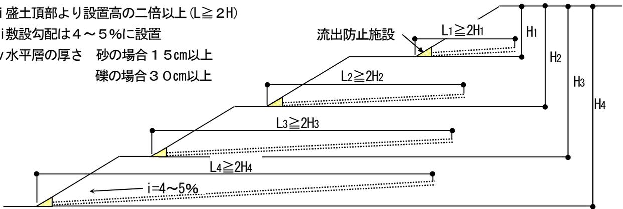
その他、水平排水層を樹脂板等特殊材を使用の場合はメーカー仕様によるが、樹脂板を使用する場合の盛土の安定性についての検討は、土の内部摩擦角が変化するので十分留意すること。
