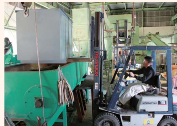
▲食品残さを機械に投入し粉砕・乾燥して飼料原料を製造
